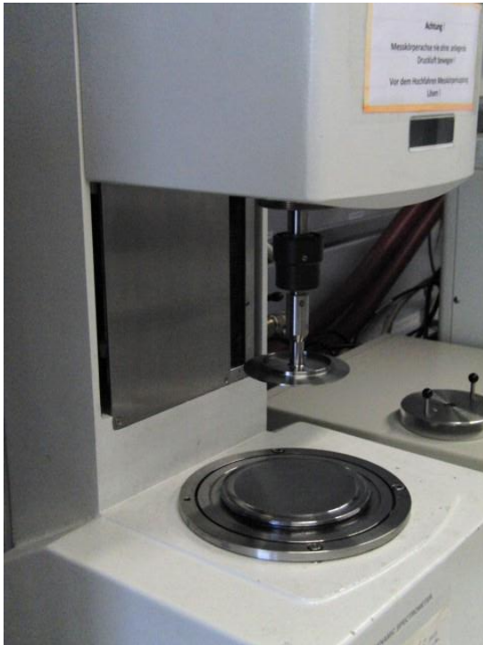
Temperierbares Rotationsviskosimeter zur Messung der Viskosität an newtonschen- und nicht-newtonschen Flüssigkeiten
